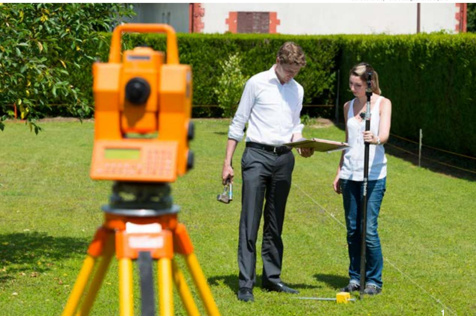
1. Réalisé par un géomètre-expert, le bornage d'un terrain permet d'identifier et de matérialiser les limites de propriété.
