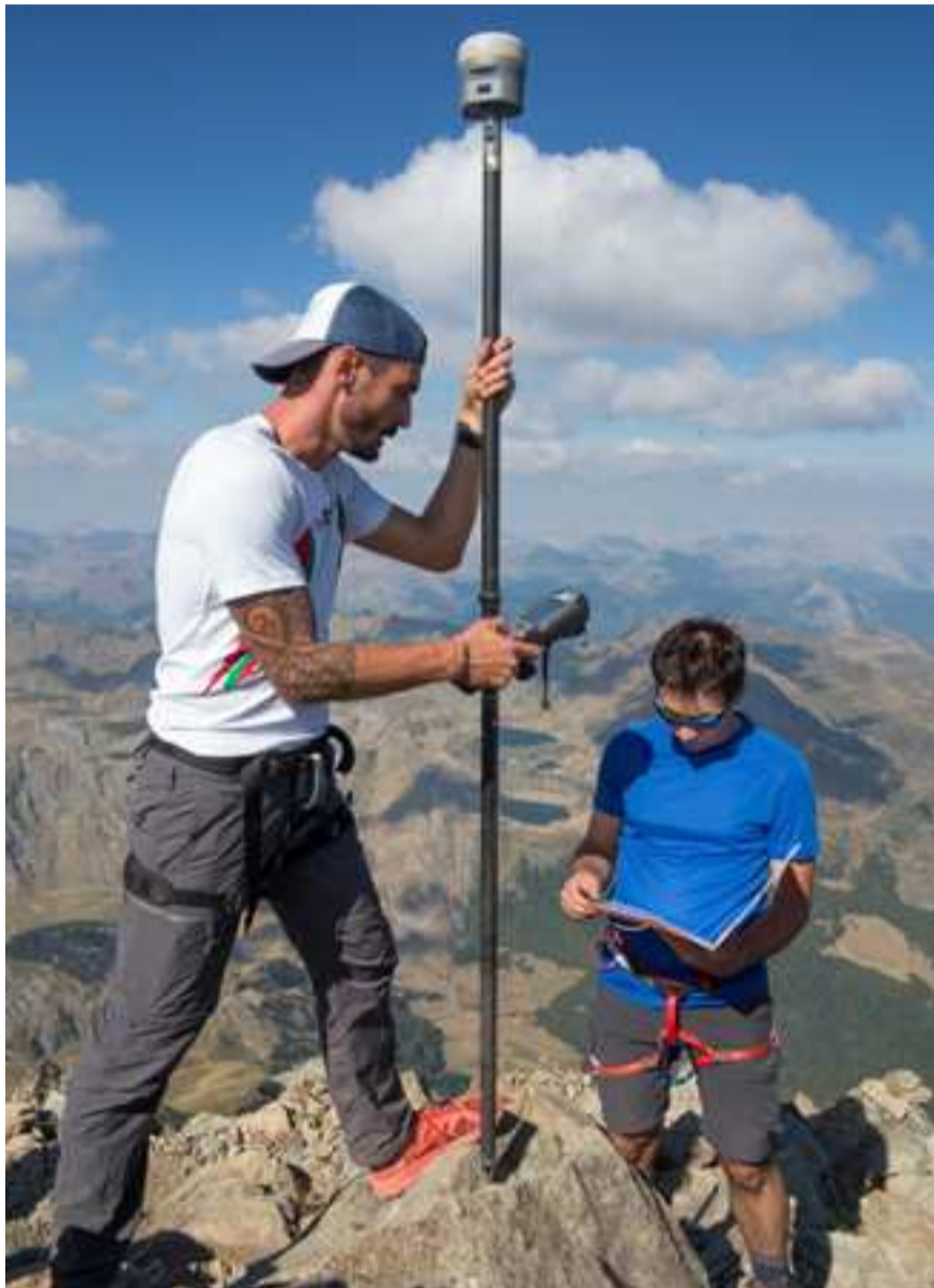
En haut de l'Ossau, l'altitude est mesurée en temps réel à l'aide du réseau Teria. © L.F.
