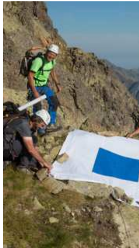
Une vingtaine de cibles ont été disposées afin de géolocaliser les photos prises par un
